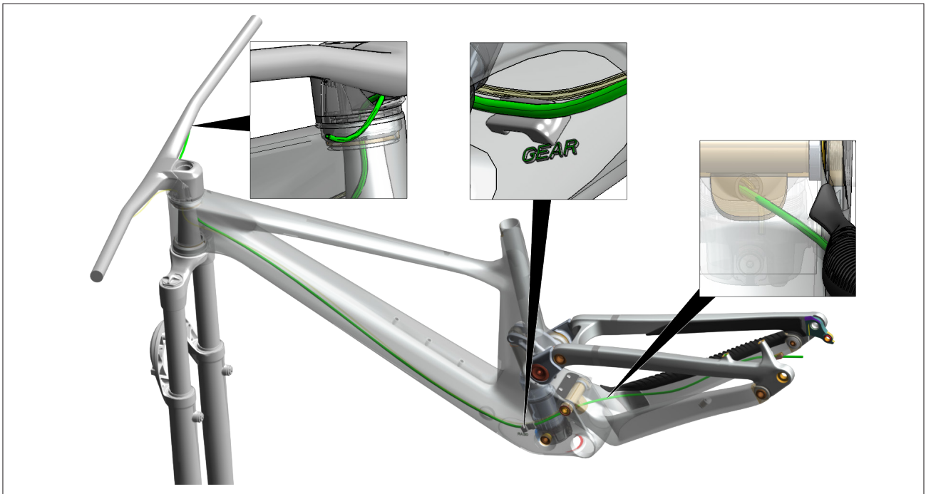
Orientamento del cavo del deragliatore posteriore
