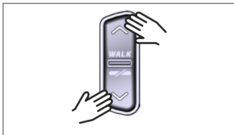
Fig. 6: Selezionare la modalità di assistenza sul HPR Remote V02/V03
